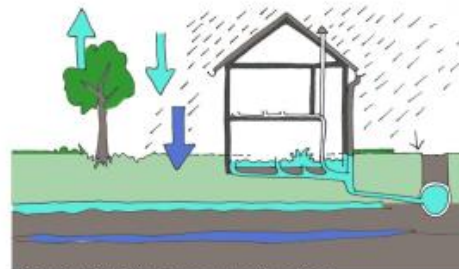
Overlast riool bij veel regen, water in woningen
